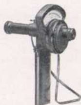
Bild 133 Tragbares Teilstrahlungs-Pyrometer, „Pyropto“
