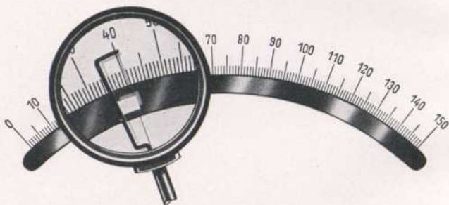
Bild 111 Skala eines Drehspul-Normalgerätes mit Fadenzeiger und Spiegelbogen, Ablesung mit Lupe. Etwa \frac{1}{2} nat. Größe
