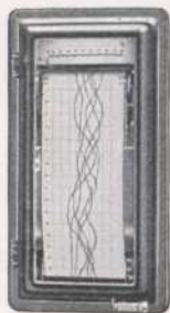
Bild 136 Sechsfarben-Punkt-schreiber für Einbau
