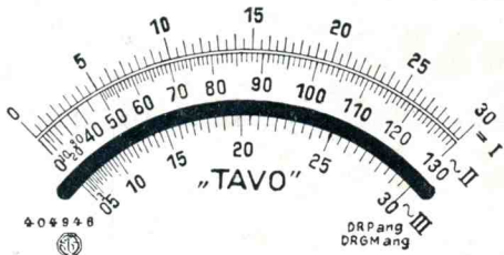
Skala des Ableseinstrumentes Type Agvva Liste Nr. 110402
