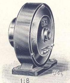
ist es vorteilhaft, den **Zungenfrequenzmesser** nicht an den betr. Wechselstrom selbst, sondern an einen **besonderen Erreger** (s. Abb.) anzuschließen, der mit dem betr. Stromerzeuger gekuppelt ist und eine Frequenz hat, die mit der des Stromerzeugers in einem festen Verhältnis steht.
