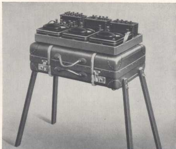
Tragkoffer mit astatischen Präzisions-Instrumenten für indirekte Wechselstrom-Leistungsmessungen, gebrauchsfertig aufgestellt.
