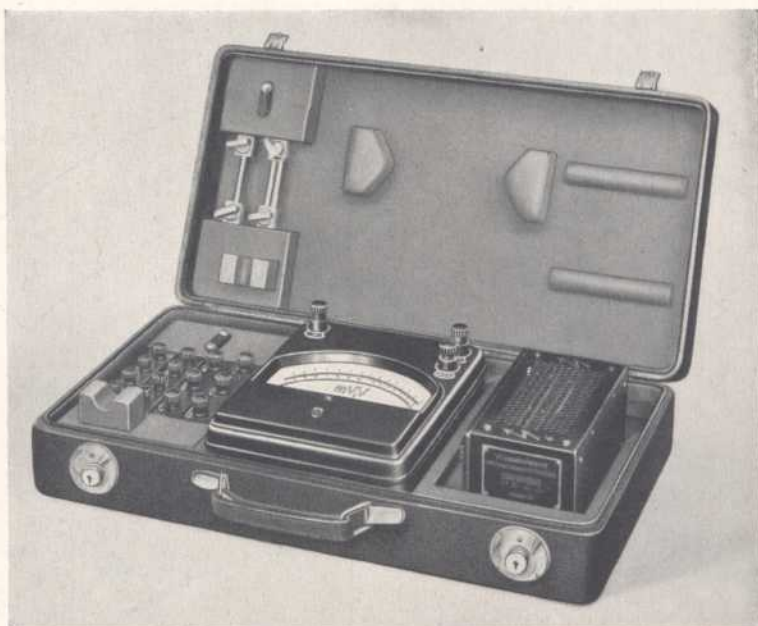
Tragkoffer mit Zehnm-Instrument der Klasse 0,2 sowie 6 Nebenwiderständen und 1 Vorwiderstand.
