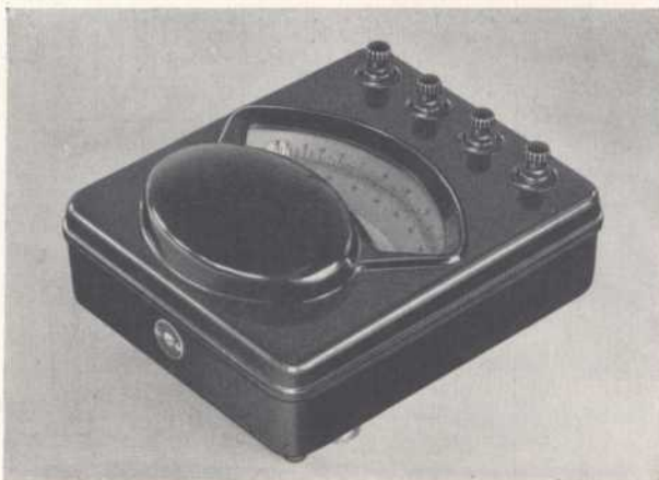
Universal-Elektrometer, verwendbar in idiostatischer, in Nadel- und Quadrantenschaltung.
