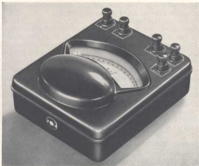
Astatischer Präzisions-Leistungsmesser mit Lichtmarke.
