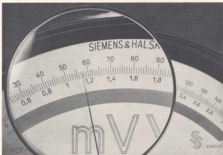
Skala und Zeiger mit Fadenspitze eines Zehnohm-Instruments mit \pm 0,1\% Genauigkeit.
