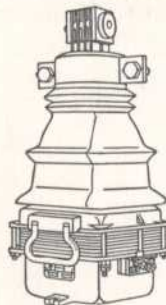
Querloch-Stromwandler für 64 kV Prüfspannung.
