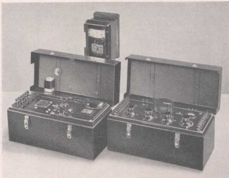
N-Oszillograph mit Anregergerät und Zeitrelais.
