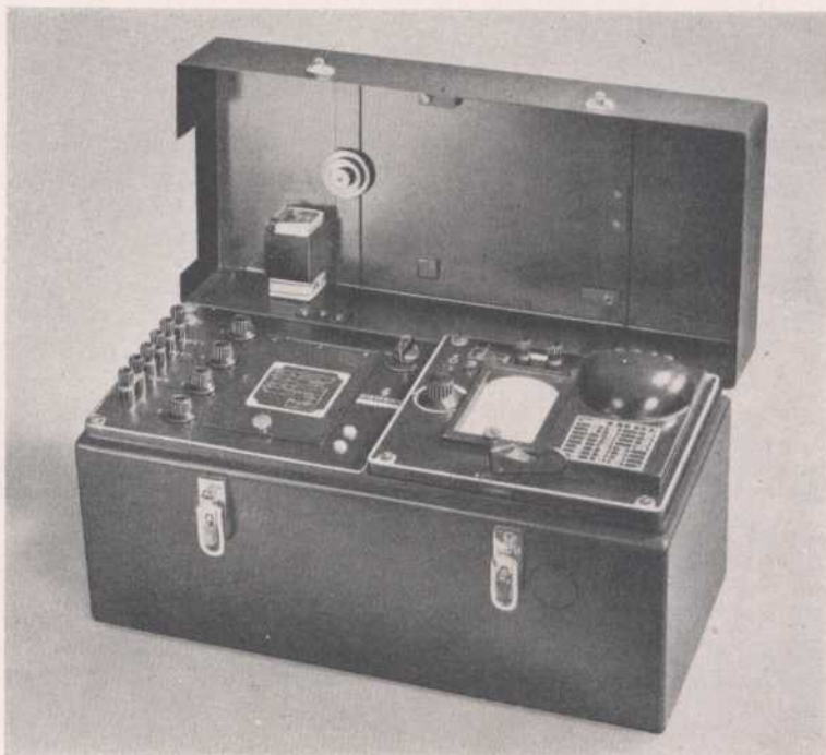
T-Oszillograph mit Grundgerät und Einsatzgerät B Listen-Nr. 157 200/157 209.
