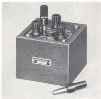
Vergleichswiderstände mit und ohne Stöpselschaltung.
